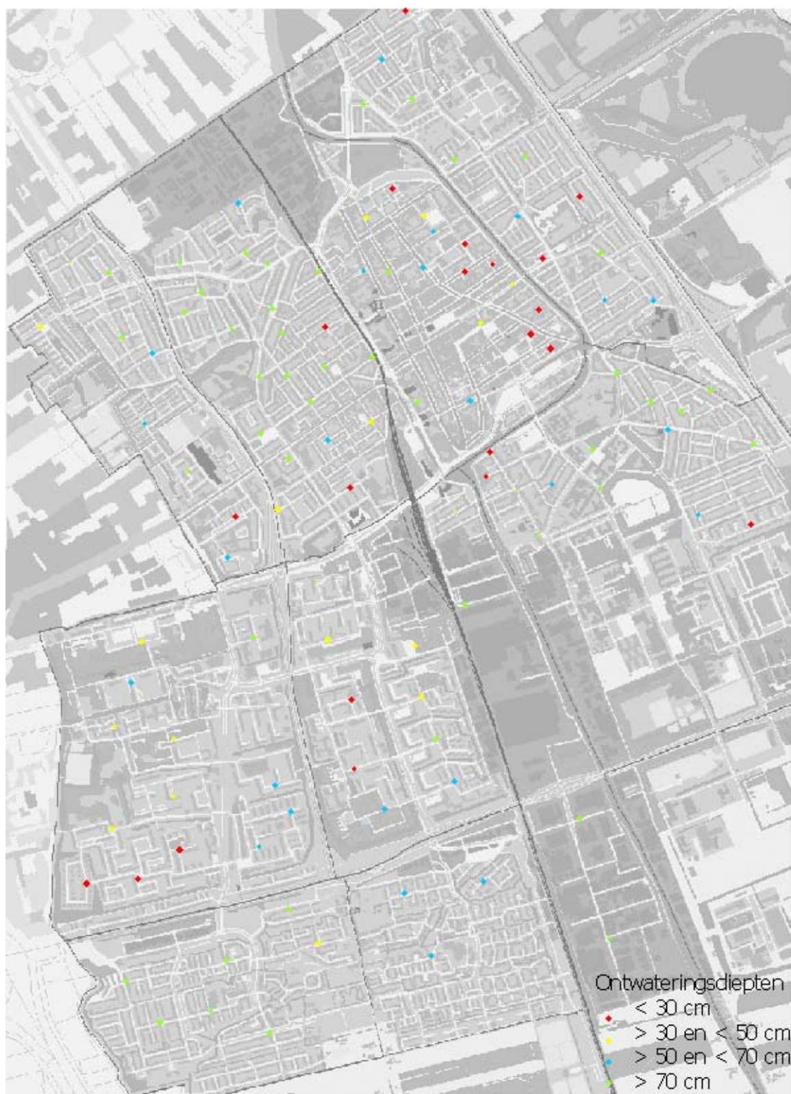
Figuur 3.1: overzicht grondwatermeetnet gemeente Delft, ontwateringsdiepte op basis van gegevens 2001
