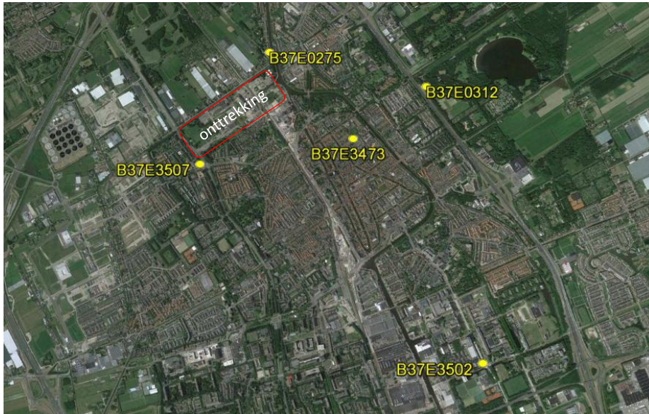
Figuur 5 locaties van de 5 peilbuizen uit het eerste watervoerend pakket
