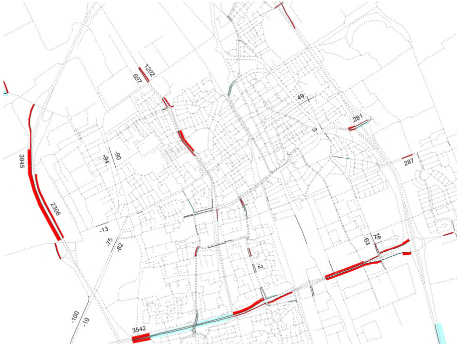
Figuur 2.5: Wegvakken in het wegennet in en nabij Delft waar het verkeersmodel op is gekalibreerd; niet afgebeeld zijn locaties op snelwegen op enigszins grotere afstanden van Delft. Rood betekent dat het verkeersmodel een hogere waarde heeft berekend dan in realiteit gemeten. Blauw betekent dat een lagere waarde is berekend dan gemeten. Voor een aantal wegen wordt ook het verschil getoond tussen het aantal berekende voertuigpassages en het aantal waargenomen passages
