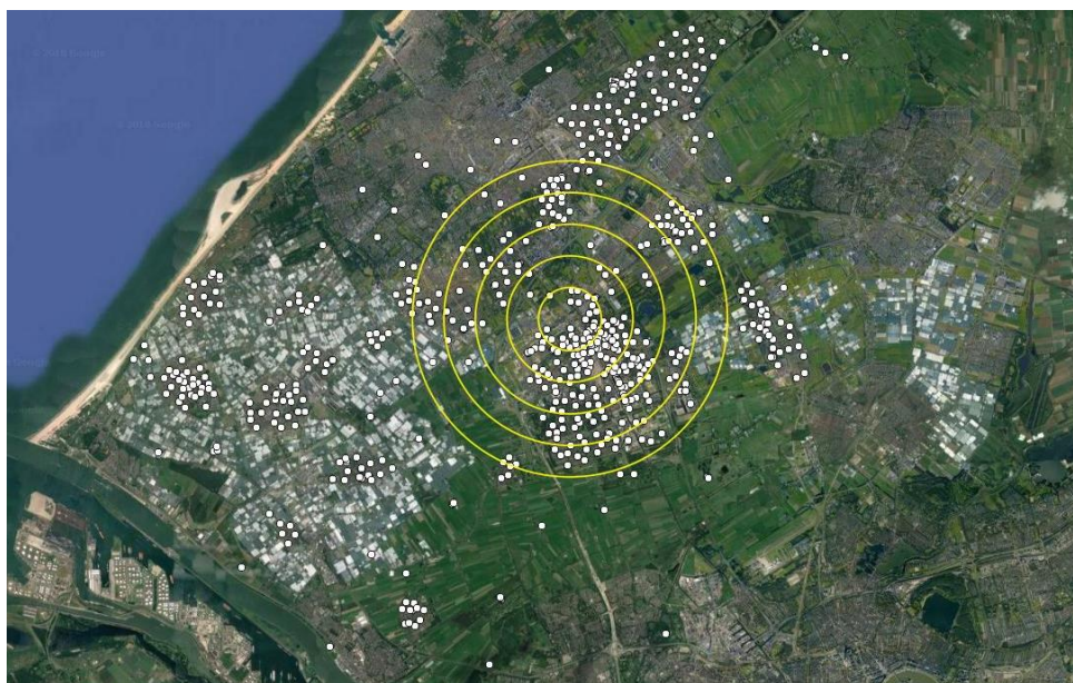
Figuur 18 De 700 Peilbuizen rond de onttrekking waar elk uur de grondwaterstand wordt gemeten.
