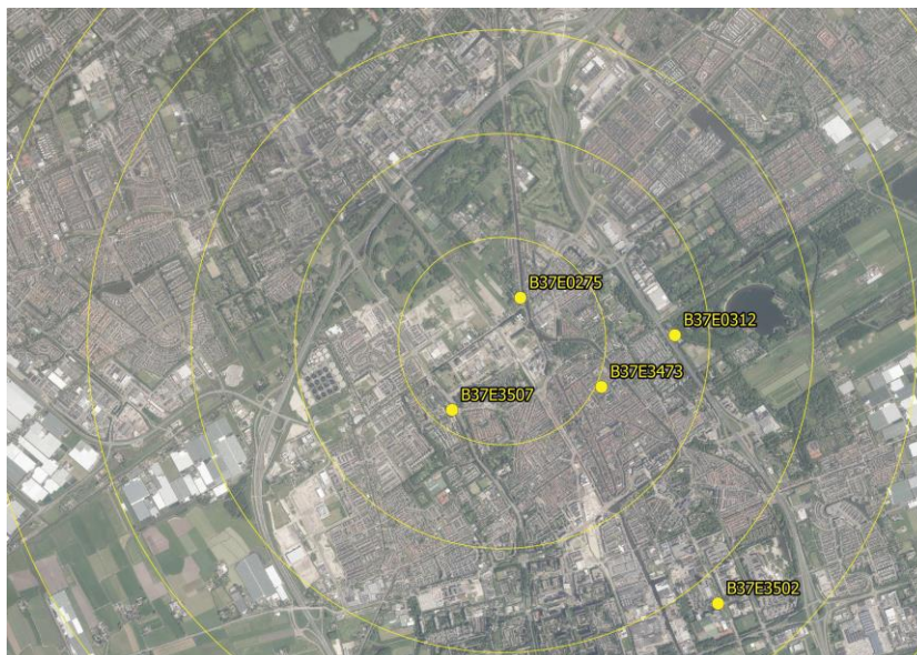
Figuur 9 De 5 peilbuizen in Delft waar conform de vergunning de stijghoogte wordt gemeten
