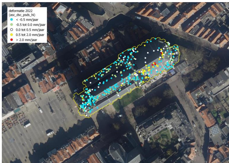
Figuur 36 De Nieuwe Kerk in Delft. Enkel bij de toren wijkt de deformatie iets af van het omringende maaiveld en het schip van de kerk.
