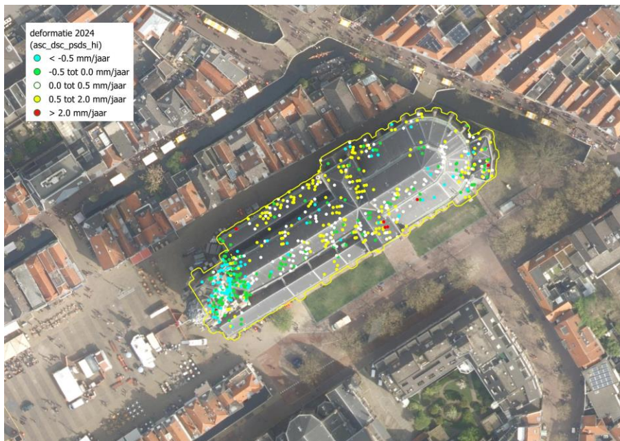
Figuur 35 De Nieuwe Kerk in Delft. Enkel bij de toren wijkt de deformatie iets af van het omringende maaiveld en het schip van de kerk.
